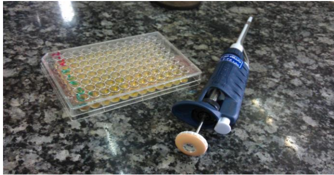
شکل ۳- پلیت ۹۶ خانه و میکروپیپت جهت انجام آزمایش
